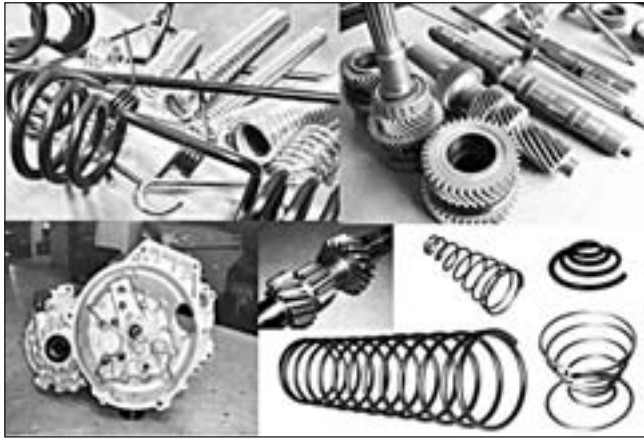
▲ شکل ۴- برخی از قطعات که تحت فرآیند شات پینینگ قرار می‌گیرند
