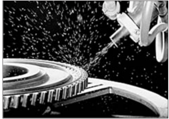
▲ شکل ۱- فرآیند شات پینینگ چرخدنده (روش Air blast)
